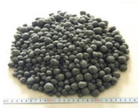
石炭灰造粒物（環境改善用） （外観：粒度 3～40mm） 土粒子密度：2.1～2.4g/cm 3 ： 自然砂（2.6～2.8）より軽量
